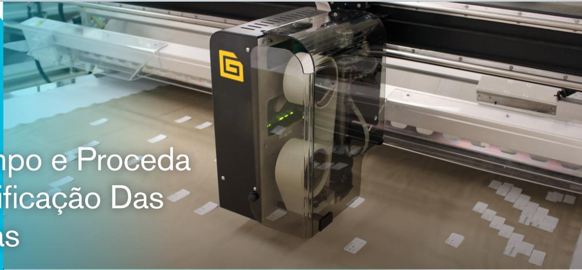
DURANTE O PROCESSO DE ESTENDIMENTO O ETIQUETADOR LABEL ID IMPRIME, E APLICA AUTOMATICAMENTE À CAMADA SUPERIOR OU INTERMÉDIAS DO COLCHÃO, ETIQUETAS CONTENDO TEXTO ALFANUMÉRICO E CÓDIGO DE BARRAS.
